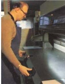
Auch bei einer Papierschneidemaschine ist eine Sicherheitsschaltung eingebaut, denn das Gerät darf nur dann in Betrieb sein, wenn die rechte und die linke Hand an der Maschine sind. Deshalb muss jede Hand einen Schalter betätigen. Würde nur eine Hand den Motor einschalten, könnte die andere unter die Schneide geraten.
