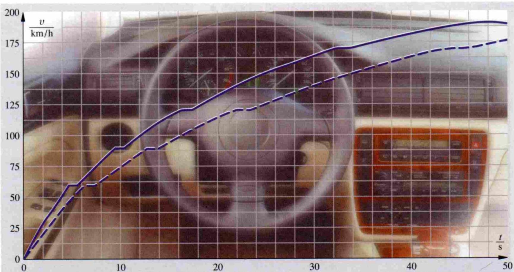
**B 1:**  $t$ - $v$ -Diagramm eines startenden Pkw mit fünf Gängen. Zweite Fahrt (gestrichelte Linie) mit voller Beladung.
