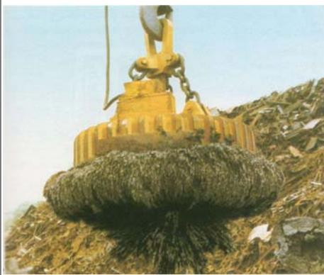
Auf Schrottplätzen müssen häufig sperrige Eisen­teile von einem Ort zum anderen transportiert werden. Die Teile werden nicht von einer Klaue er­fasst, sondern hängen un­ter einer dicken Platte. Es sieht so aus, als wäre dies ein großer Magnet.
